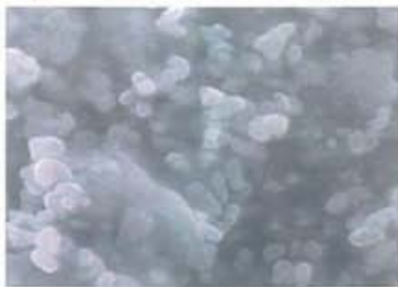
Nanosilber unter dem Raster-Elektronen-Mikroskop. Die Silberteilchen haben einen Durchmesser von ca. 13 nm.
